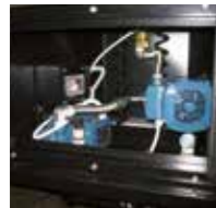
2 pompe d'acqua a girante periferica che permettono di lavorare con 2 modalità di pressione e consumo 2 booster pumps with peripheral impeller, allowing 2 different pressures and consumptions
