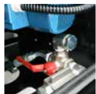
Possibilità di lavoro da rete idrica con bypass serbatoio Able to work with water supply network with bypassed tank
